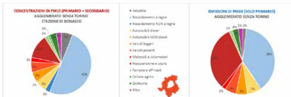
Figura 5.8.3.2: Contributi percentuali alle CONCENTRAZIONI medie annuali (a sinistra) presso una stazione rappresentativa dell'Agglomerato (stazione di Beinasco) e alle EMISSIONI comunali annuali (a destra) dell'Agglomerato di Torino
